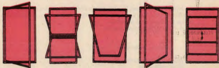
a - nyíló b - bukó c - emelkedő d - billenő e - forgó f - toló
